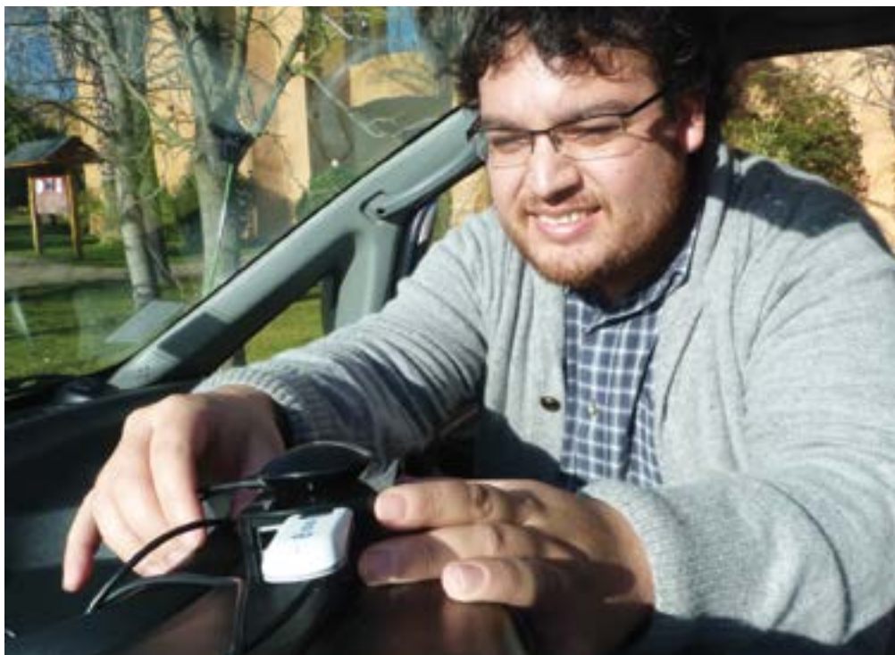
El microcomputador se instala en las cabinas de los camiones para que emita la señal a los usuarios.
