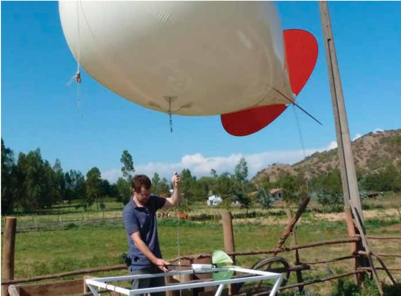
Los sensores que lleva el globo captan información sobre humedad, temperatura, altitud, velocidad y dirección del viento, entre otros aspectos.
