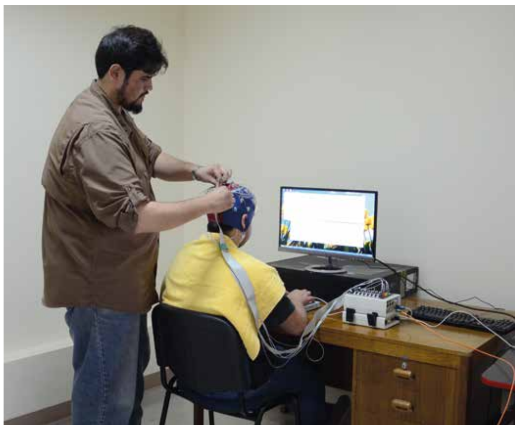
Para obtener información científica sobre la memoria y el aprendizaje, se construyó un sistema de respuestas que incluye la tecnología del electroencefalógrafo, equipo que registra y grafica las descargas eléctricas de la corteza cerebral.
